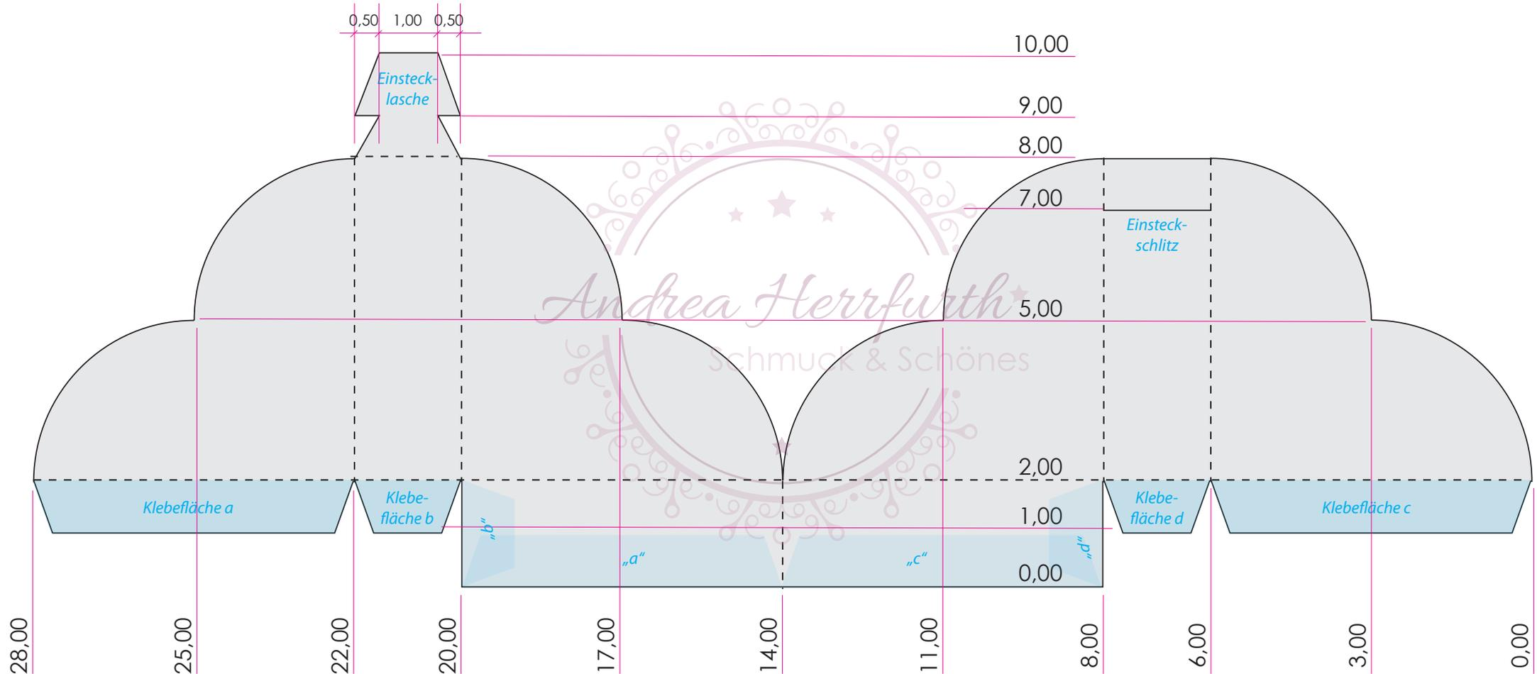
**schmale Mini-Klappbox mit Wellenkante -> die fertige Box hat ein Maß von 6/6/2cm**
